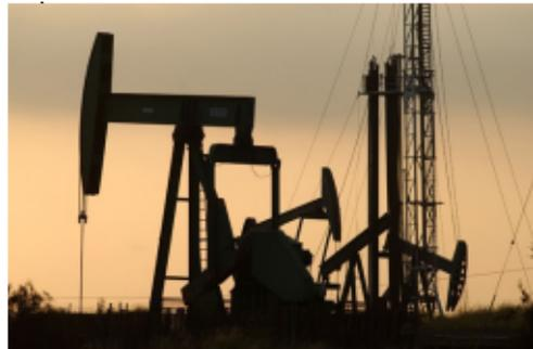
**Exploitation** Si le pétrole est au rendez-vous et que la **viabilité économique du projet** est avérée, on effectue des **forages de production** pour exploiter le gisement. Si la pression dans le réservoir est supérieure à la pression atmosphérique, le pétrole sort naturellement du puits (15 à 20% du contenu). Pour aller plus loin, on fait appel à d'autres techniques (récupération secondaire et assistée).
