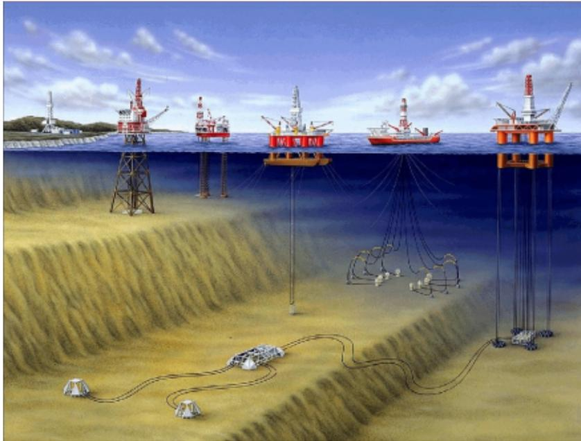
Un gisement d'hydrocarbures peut être exploité *on-shore* - **sur terre** - ou *off-shore* - **en pleine mer**. Outre les plate-formes fixes, les moyens ont bien évolué : auto-élévatrices, semi-submersibles, bouées (SPAR) et navires à positionnement dynamique (FPSO).
